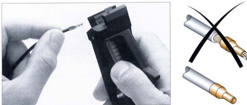
Crimpado de punteras o casquillos
